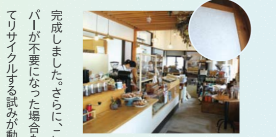
● 店舗は築50年以上の古い剣道場をリノベーション。床や梁はそのままに、焙煎で出るコーヒーのかすや外皮を内壁のしっくいに混ぜてあります。
