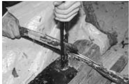
「しじり」という機械の刃の部分に樹皮をあててはさみ、表皮と白皮を別けていく。
