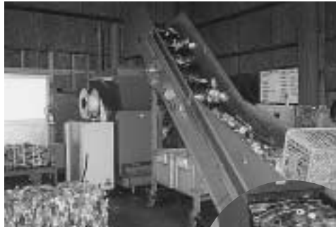
選別されたPETボトルは、ベルトコンベアーで減容機に運ばれ、圧縮・梱包される。
