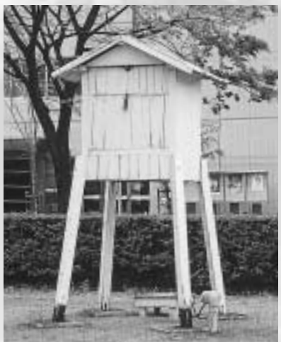
岡山地方気象台の露場には、百葉箱と観測機器類等が置かれています。(道路からすぐ見える場所にあります)
