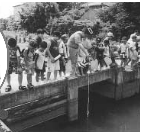
平成12年7月「水辺ふれあい教室」で児島湖周辺の川の透明度を調べる様子。「児島湖博士」に扮した職員が30cmの白い板を沈めていき、どこまで白い板が見えるか確認し、川の透明度を測定しました。
