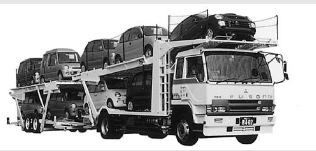
センターアックス型フルトレーラー（まん中に車輪がある）（株）丸文独自の設計・製作によるトレーラー。
