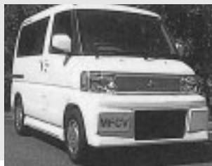
燃料電池自動車の試作車 水素と空気中の酸素を化学反応させて電気を取り出し、その電気でモーターを動かす燃料電池自動車。将来のクリーンエネルギー車として期待されています。
