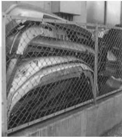
バンパーの回収 販売会社でリサイクルを目的に修理交換時の廃バンパーを回収。樹脂再生メーカーを経て、部品メーカーで自動車部品に再生されています。
