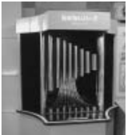
弦のないハーブ 光センサーに手を入れると、ピアノなど6種類の音が出せる装置です。
