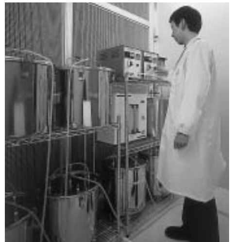
建材のホルムアルデヒド放散量測定風景
