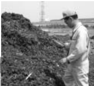
検温器を使った安全管理。投棄場所での温度測定のほか、抜き打ち検査も行います。
