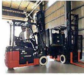
充電済みのバッテリーを複数常備し、都度交換することで電力使用量の平準化に効果を上げています。
