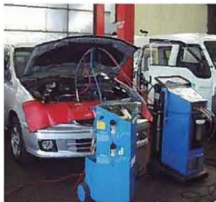
特殊な装置を使ってエンジンを分解せずに洗浄する「エコ整備」。
